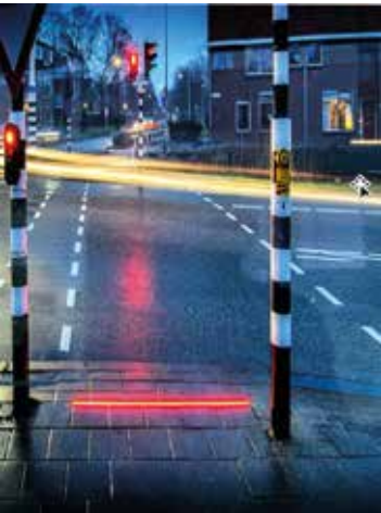
Optische Schranken sorgen auch bei schlechten Wetter-verhältnissen für Aufmerksamkeit.
