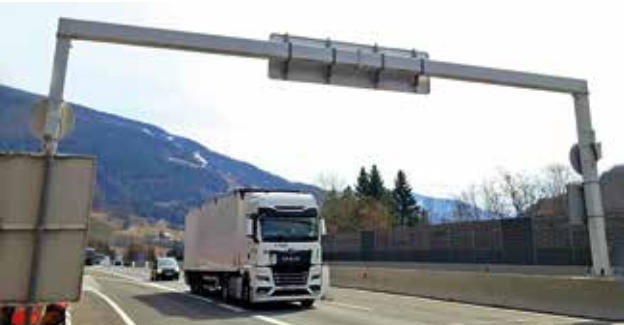
Unser lasergestütztes Breitenmesssystem sorgt auf der Schilderbrücke für die zuverlässige Erfassung der Fahrzeuge.
